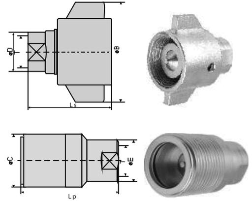
**Aplicaciones:** Estos acoples con una tuerca "mariposa" de servicio pesado han sido diseñados para el uso en líneas hidráulicas donde se requiere una desconexión sin derrames y con mínima penetración de aire. Son ideales para camiones volcadores hidráulicos, equipamiento de campos petroleros y todas aquellas aplicaciones en que se requiera la posibilidad de acoplar y desacoplar bajo presión.
